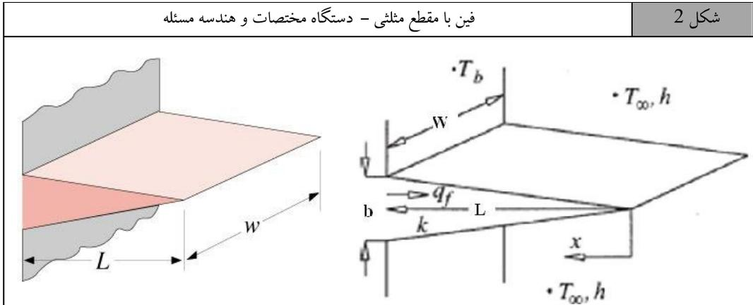
فرض کنید که در این فین مثلثی  $W \gg L$  است و  $L=7\text{ cm}$  و  $b=2\text{ cm}$  باشد. با استفاده از روش حجم کنترل معادله‌ی انرژی را در حالت پایدار منفصل نمایید. محاسبات را برای فولاد نرم به همراه 30 حجم کنترل داخلی انجام دهید. خصوصیات فولاد نرم به شرح ذیل است:
