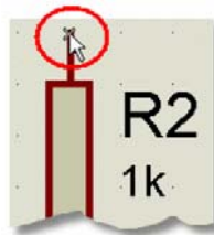
شکل (۳-۵). نحوه نمایش المان مقاومت در نرم افزار پروتئوس در هنگام برقراری اتصال
