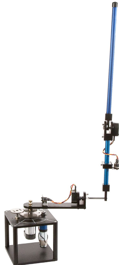
شکل ۱- سیستم آونگ معکوس دابل دوار شرکت کوانزر
